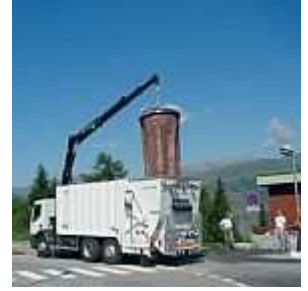
Der Sack wird über das Fahrzeug geschwenkt und geleert. Dann zurückgesetzt und mit einem neuen Hygienebag versehen.
