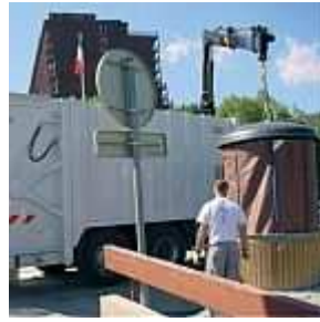
Der Fahrer hebt den Tragesack mit dem Kranarm aus dem Container
